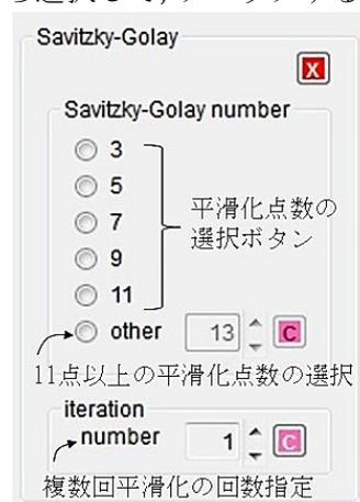
平滑化を終了する場合には、[Savitzky-Golay]グループボックスの赤い[X]ボタンをクリックする。平滑化を取り消して、処理前のスペクトルを表示させたい場合には、スペクトル表示画面の右側に出現している緑の[X]ボタンをクリックすると元のスペクトルが現れる。なお、平滑化を何回か繰り返した場合には、緑の[X]ボタンをクリックするごとに、処理直前のスペクトルが出現する。
